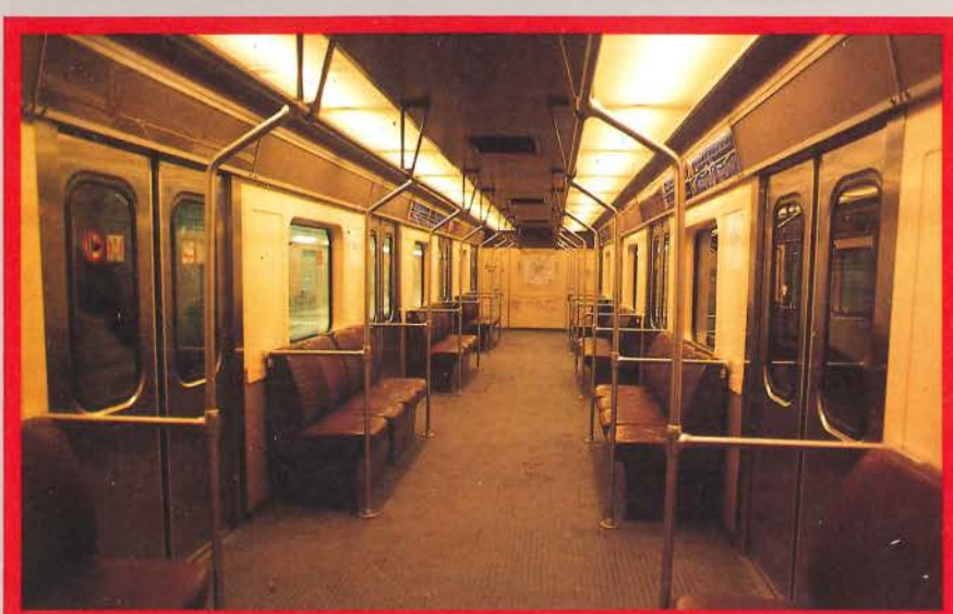
Coche tipo 5.000 reformado. Los asientos corridos permiten mayor capacidad y mejoran la calidad del servicio.
