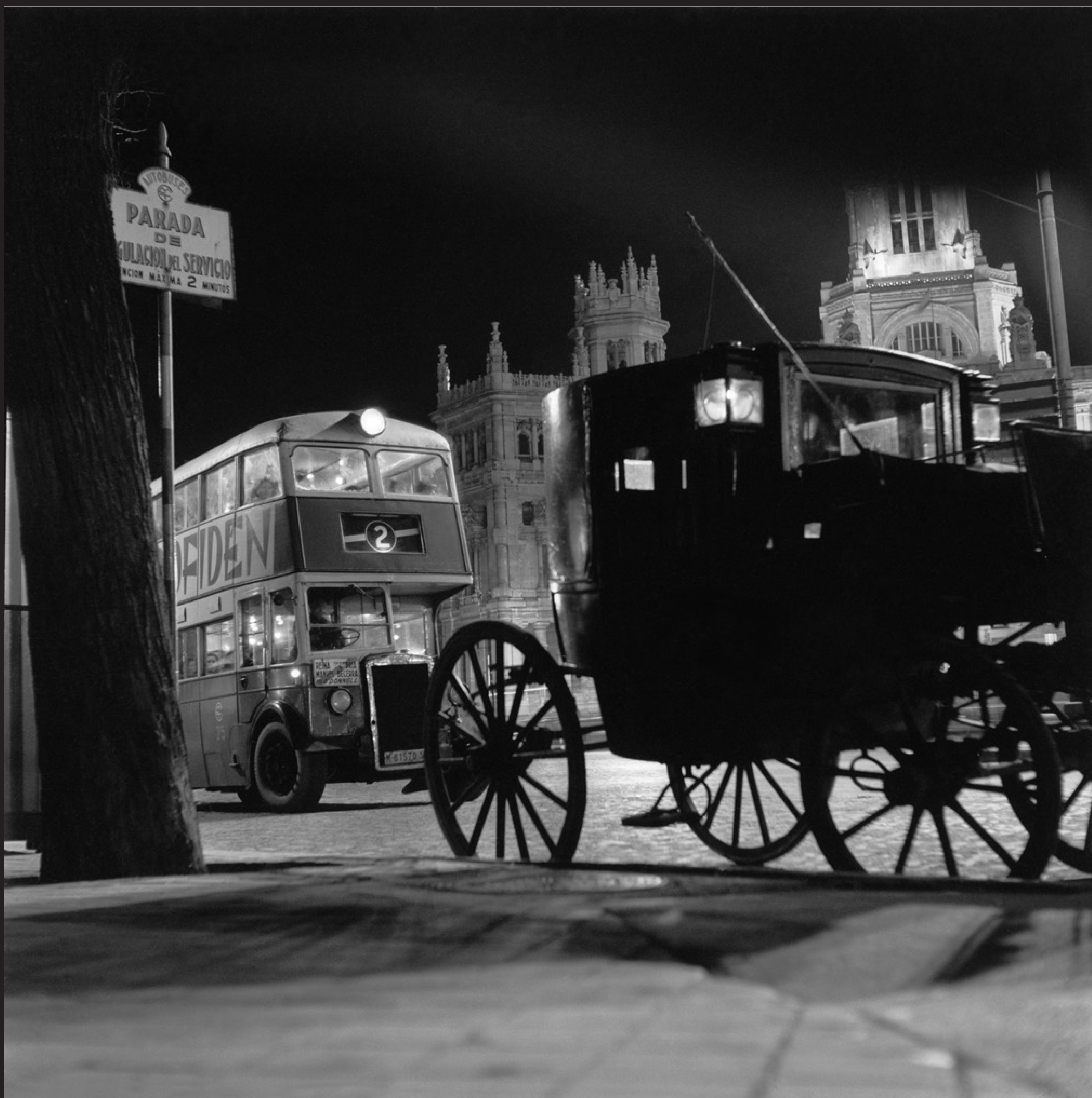
Autobús Leyland Titan OPD2. Carrocería de dos pisos construida por Carde y Escoriaza. Línea 2 (barrada) de Manuel Becerra a Reina Victoria por O'Donnell. (circa 1954).
