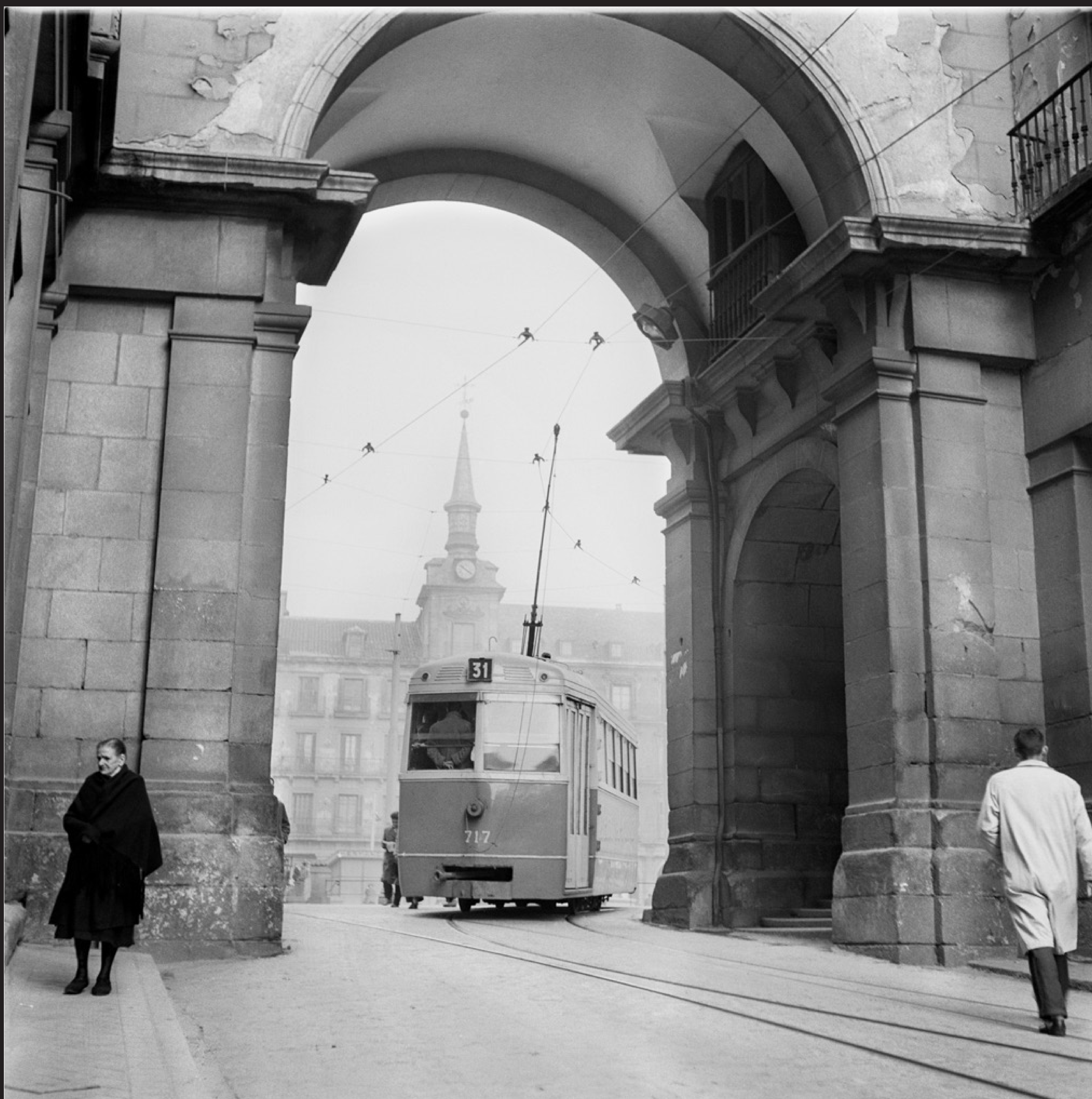
Tranvía Charleroi VI modernizado con una caja de tipo unificado. Pertenece a la línea 31, Plaza Mayor-Carabanchel Bajo, con un servicio corto de Pza. Mayor a Mataderos. (circa 1954).
