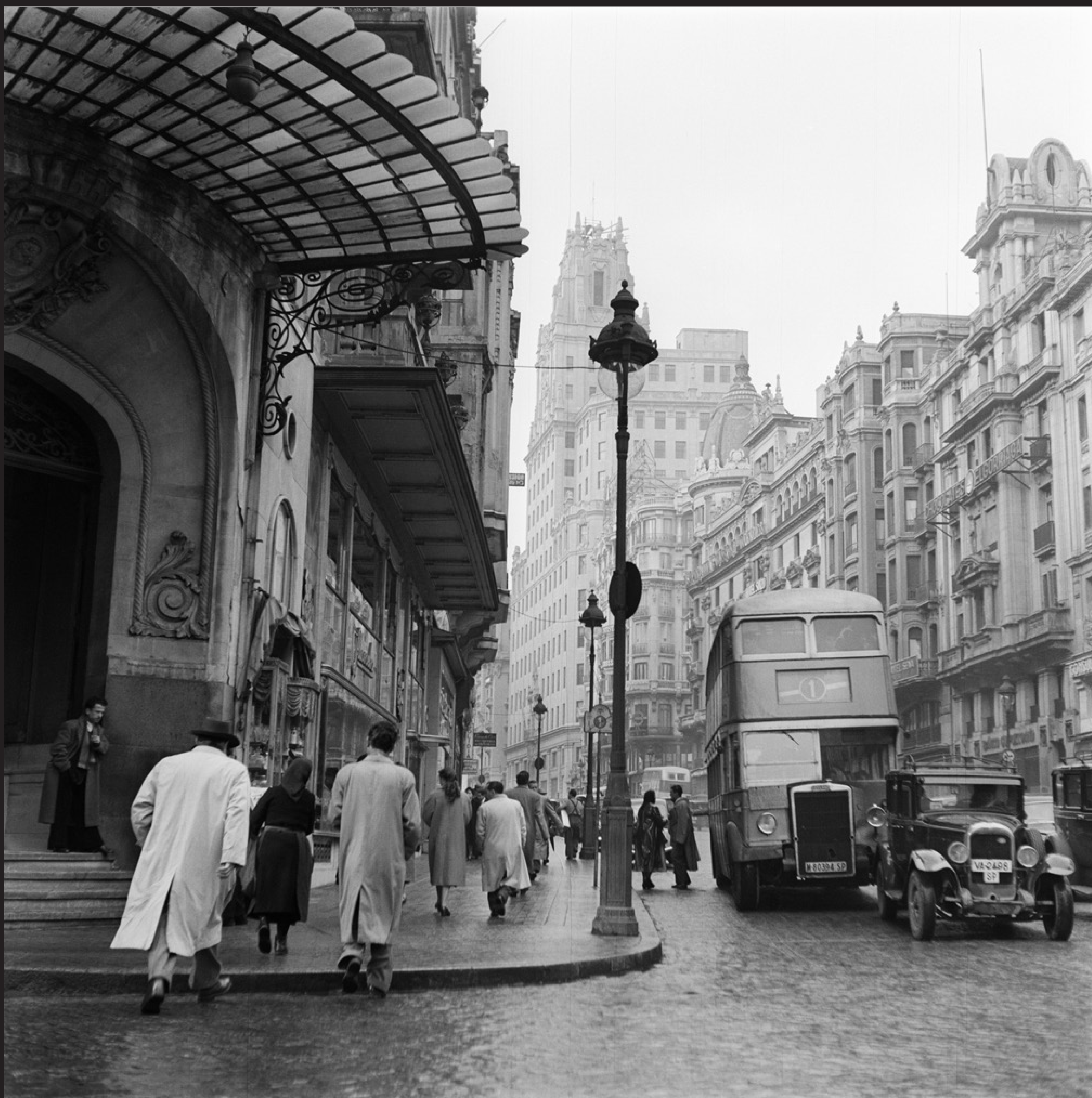
Autobús Leyland Titan OPD2. Carrocería de dos pisos construida por la Compañía Auxiliar de Ferrocarriles. Línea 1 (barrada), de Cea Bermúdez a Cartagena por Princesa. (circa 1954).
