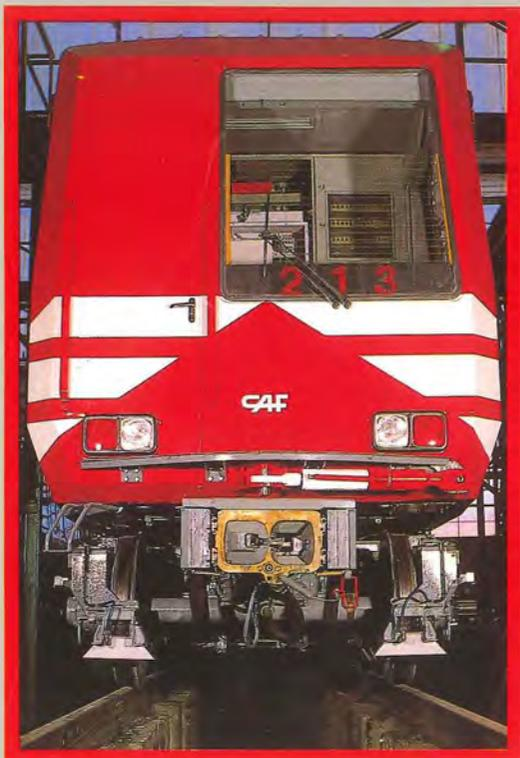
Coche serie 2000 equipado con Sistema de Protección Automática de Trenes (ATP).
