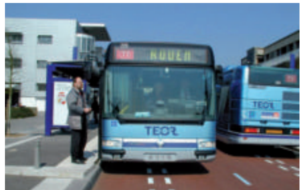
Figura 73: Accesibilidad al andén mediante guiado óptico
