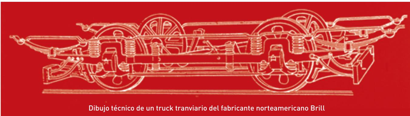
Dibujo técnico de un truck tranviario del fabricante norteamericano Brill
