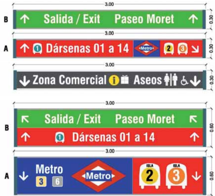
Ejemplo de aplicación de señalización direccional (Intercambiador Moncloa) Directional signs example (Moncloa Interchange Station)
