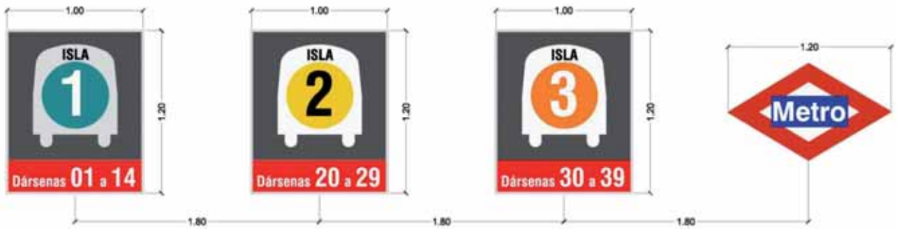
Ejemplo de señalización de islas (Intercambiador Moncloa) Islands signs example (Moncloa Interchange Station)
