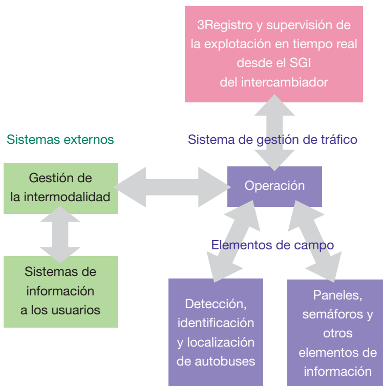
Elementos lógicos principales del Sistema de Gestión de Tráfico The main logical elements of the Traffic Management System
