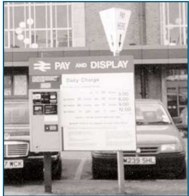
Sistema típico de venta de tickets de aparcamiento para colocar en el parabrisas, que funciona con monedas, en Doncaster (Reino Unido).
